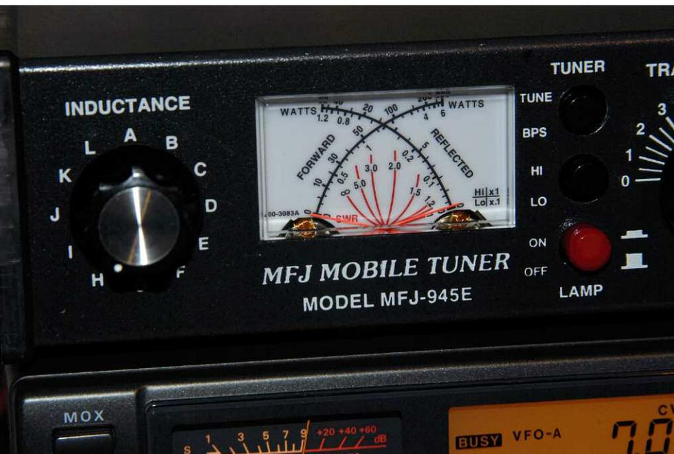
Notamment, même si aucune prise particulière n'a été prévue pour cela, la notice indique clairement qu'un long fil peut être utilisé simplement en l'insérant dans le connecteur central de la fiche SO-239 à l'arrière. Evidemment, cela nécessite une bonne mise à la terre du coupleur, au risque de se brûler les doigts.
