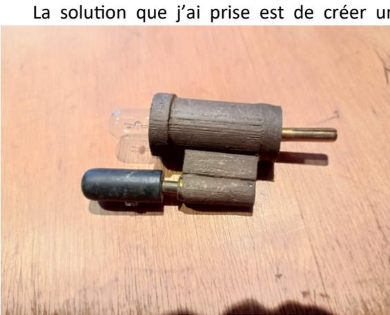
La solution que j'ai prise est de créer un ensemble à partir de fiches de 4mm « bananes ». Lorsqu'on a effectué l'accord on retire le dispositif et le fil d'antenne est immédiatement disponible.
