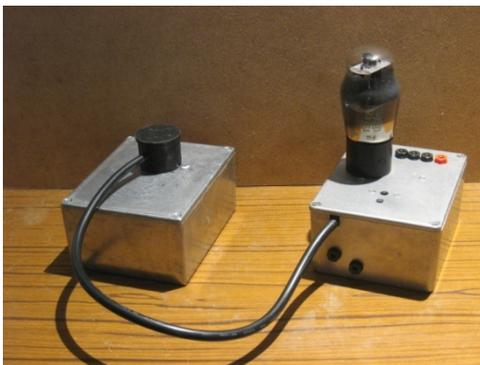
Pour une raison de commodité j'ai séparé le circuit de cathode (pour la manipulation) et je l'ai câblé en prenant comme support les socles « bananes » du manipulateur, isolées du boîtier. Deux fils ordinaires font la liaison entre les deux systèmes.
